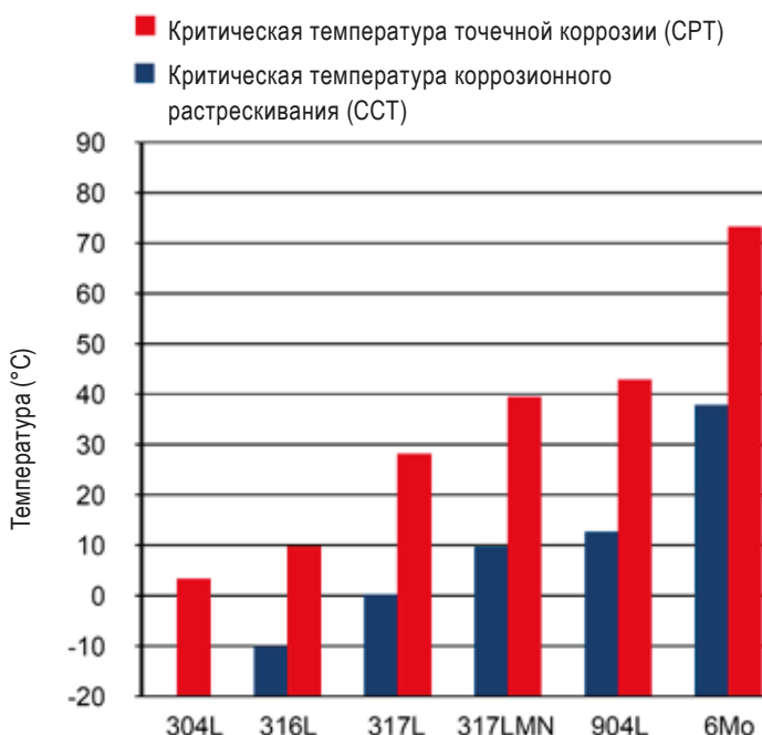
Рис.: Критические температуры точечной коррозии и коррозионного растрескивания для различных сплавов, рассчитанные по результатам испытаний ASTM G48
