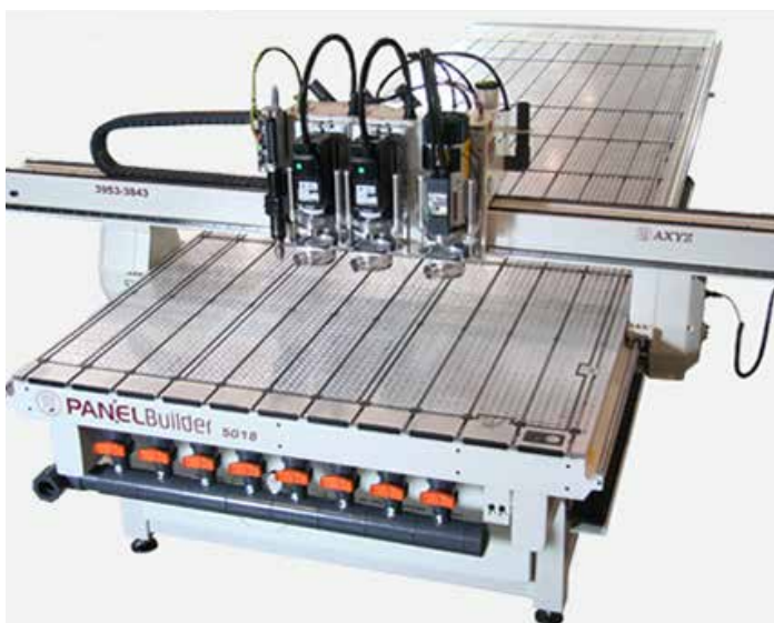
Abb. CNC Bearbeitungszentrum, Panel Builder von XYZ International
