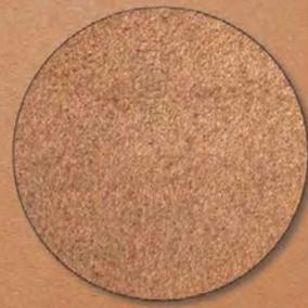
*TECU® Premium est un alliage de cuivre novateur avec une petite proportion d'étain de haute qualité pour une transformation simple, une apparence extraordinaire dès le début et une oxydation intensive et rapide.*
