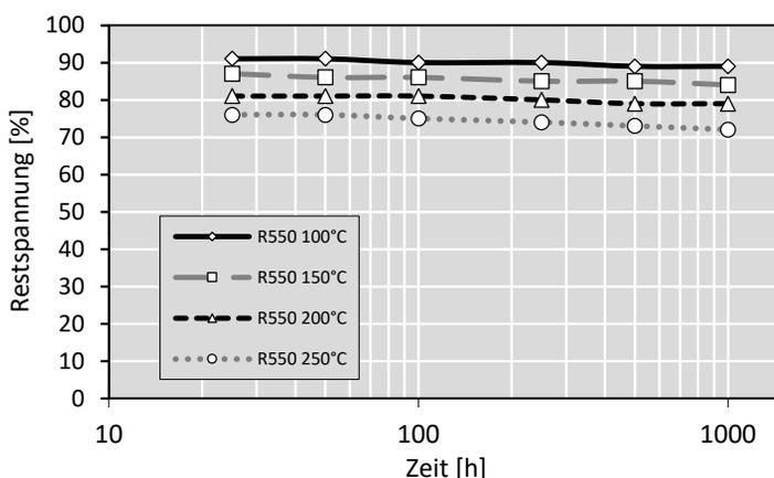
Spannungsrelaxation ist die Verringerung der Spannung unter Zeit und Temperatureinfluss.
