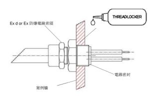
請按以下步驟完成線口封裝,將自攻銅杯蓋擰在電纜護套上, 套進線口後 銅杯用夾具固定,以順時針旋進攻牙,將孔的內部 放在銅護套上.
