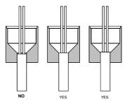
操作過程中將銅杯內氧化鎂粉末振掉(切忌口吹).
