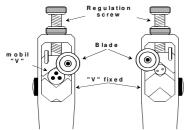
手握工具順時針旋轉,同時向內輕推,如皮屑太長,用鉗徐掉. 到足夠長度,用 V 形位置夾緊以限制工具繼續進刀,旋轉一週 後可得平滑之 90 度切口.
